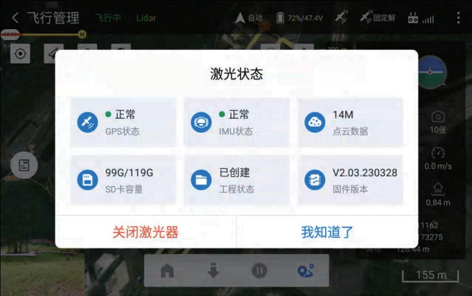
b.飞机遥控器实时查看激光状态,自动化控制激光雷达和POS启停。
